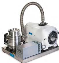
Sistema de bombeamento turbo TPS-mobile, bomba turbo TwisTorr 305 FS, DN 100 CF-F (CFF de 6"), bomba primária IDP-7 dry scroll, sem medidor de pressão, cabo elétrico padrão americano
